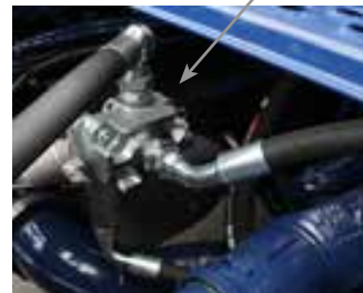
Am Chassis verbautes Kippventil
